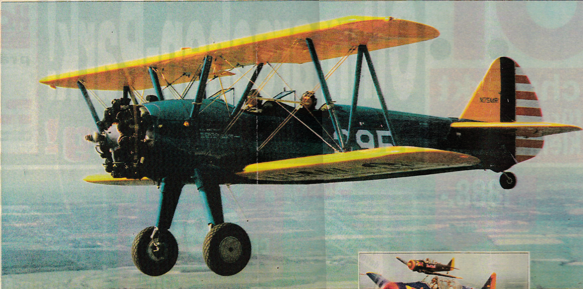
Auf dem Doppeldecker Boeing B75N1 „Stearman“ lernten zahlreiche US-Kriegsflieger und Zivilpiloten das Fliegen. Die „Stearman“ hat einen 220-PS-Continental-7-Zylinder-Sternmotor und wurde 1991 restauriert. Fotos: ORVILLE-FLUG
