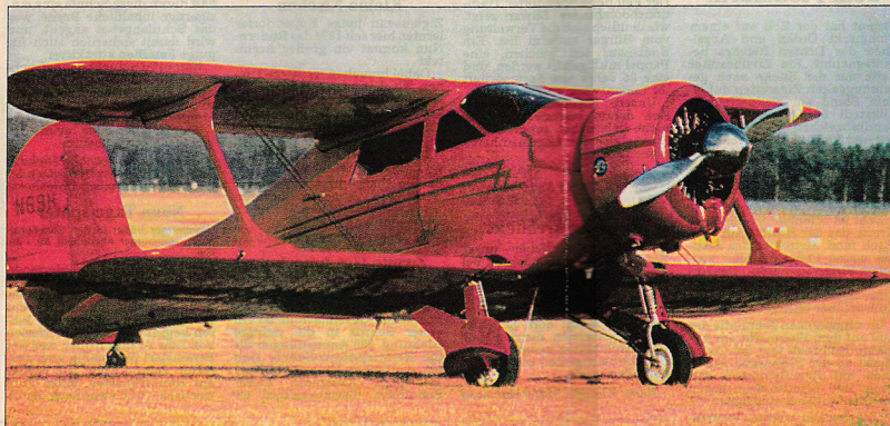
Eine absolute Rarität bei den Airport Classics: Die Beechcraft „Staggerwing“ aus dem Jahrgang 1943 erreicht mit einem 450-PS-Sternmotor immerhin eine Geschwindigkeit von 320 km/h und 8600 m Höhe.
